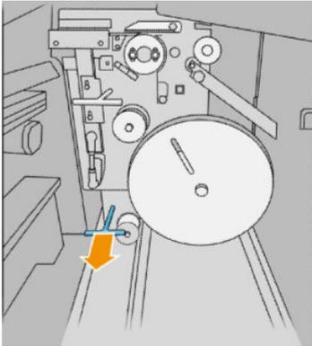
3. Faites pivoter la protection des étiquettes pour la retirer.
