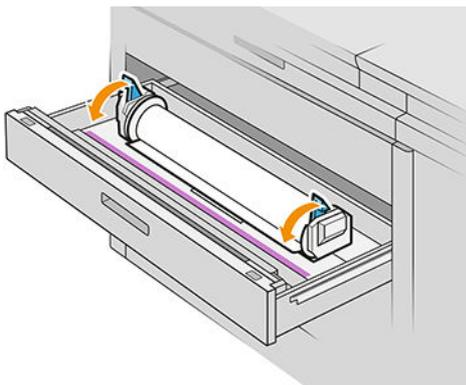
9. Insérez le papier dans le logement prévu à cet effet : Le logement avant pour le rouleau avant et le logement arrière pour le rouleau arrière.
