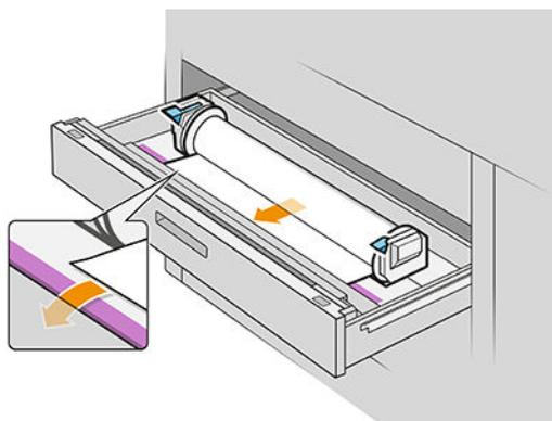
**ASTUCE :** Le rouleau arrière peut nécessiter un tour supplémentaire pour faciliter le chargement automatique. N'interrompez pas l'insertion tant que le papier n'avance pas automatiquement.
