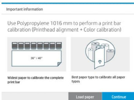
**REMARQUE :** Il est fortement recommandé d'utiliser du polypropylène mat HP Production, 40 pouces (1016 mm) de largeur, pour étalonner la barre d'impression.
