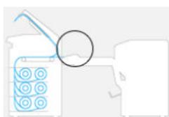
1. Ouvrez le capot du dépliant pour arrêter le moteur de la plieuse et lui couper l'alimentation.
