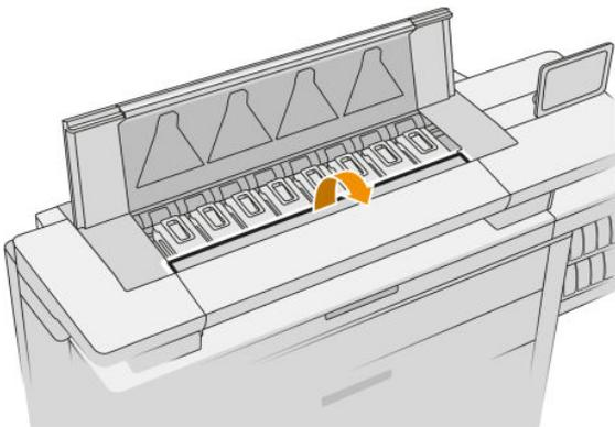
7. Identifiez la ou les têtes d'impression à remplacer.
