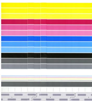
Si vous voyez des défauts, vous devez étalonner l'imprimante en appuyant sur **Étalonner la barre d'impression** dans l'application d'optimisation de la qualité d'impression. Vous devez également étalonner l'imprimante si vous savez que l'étalonnage d'un rouleau est en attente.
