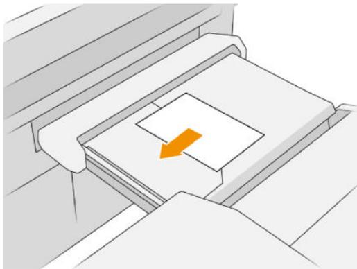
4. Déplacez le bac vers le centre. Le rail d'insertion sur la table peut être glissé dans la position optimale pour le document que vous insérez.
